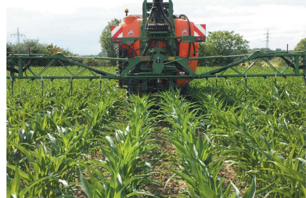
Droppleg UL обеспечивает надежное внесение СЗР в посевах кукурузы
